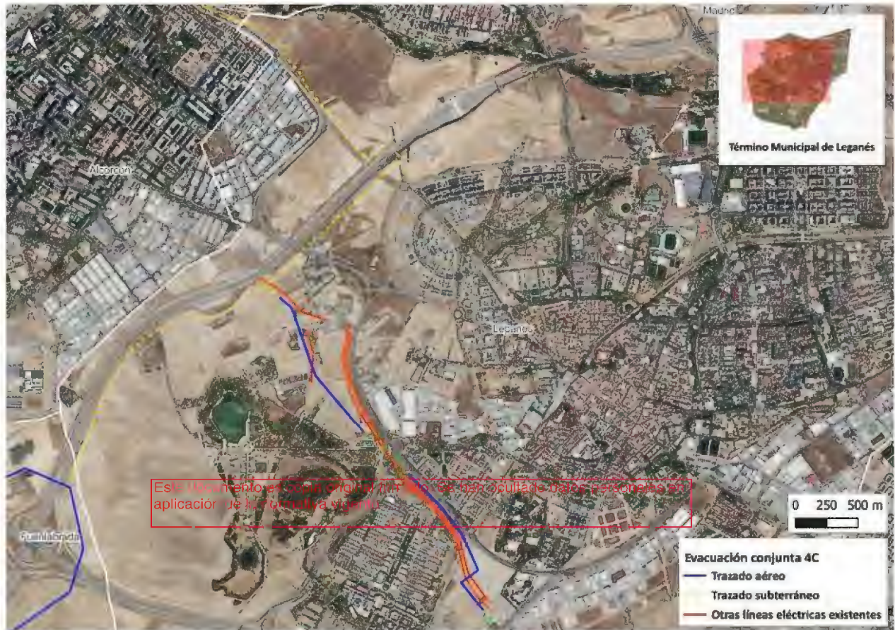
Línea de evacuación aéreo -subterránea a su paso por el TM de Leganés, y otras líneas eléctricas existentes a su llegada a la subestación Leganés 220 kV (REE)
